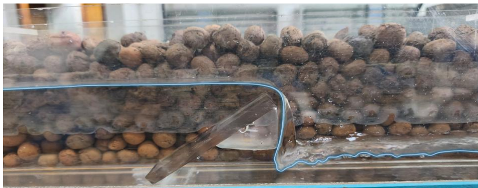
Figura 2 – Detalhe do vertedor retangular inclinado com superfície livre em evidência.
