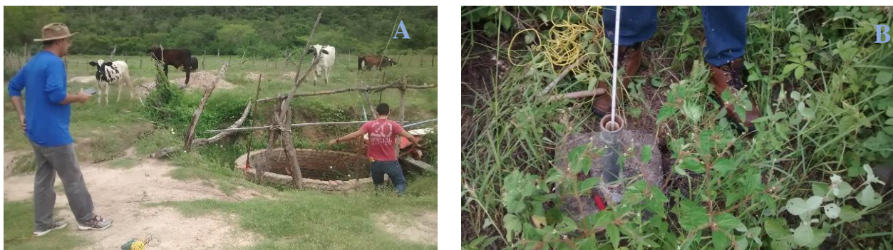
Figura 2. Coleta de água em poço (A), piezômetro (B), no vale aluvial do rio Ipanema em Pesqueira (PE).
