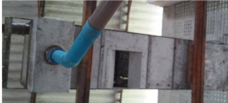
Figura 2 – Simulador de Chuva de intensidade variável
