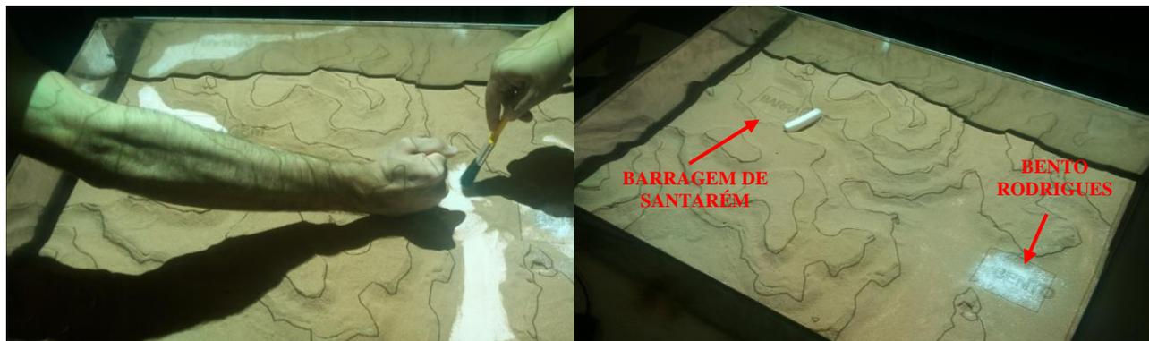
Figura 6 – Lado esquerdo; suavização dos desníveis ocasionados pela espessura das chapa de poliestireno expandido, lado direito; Projeção das curvas de nível sobre o modelo reduzido do relevo do Distrito de Bento Rodrigues, em Mariana-MG.
