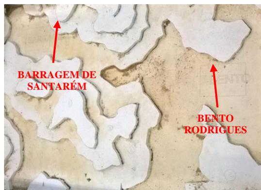
Figura 5 – Chapas de poliestireno expandido sobrepostas durante a construção do modelo reduzido.
