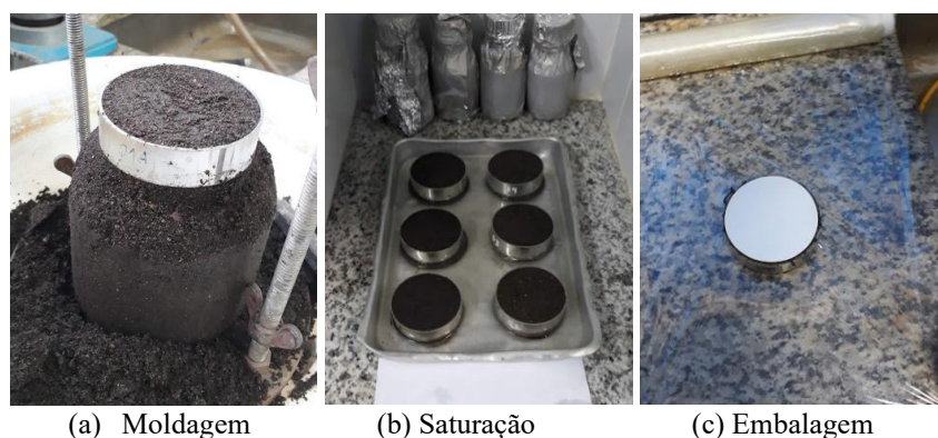
Figura 1 – Ensaio de sucção pelo método do papel filtro para os cinco materiais
