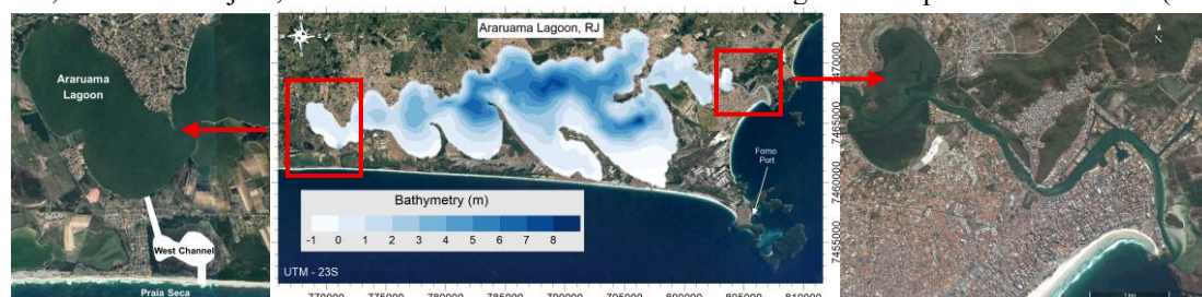
Figura 4 – À esquerda, canal de maré proposto para a região oeste da Lagoa de Araruama, apresentada ao centro. À direita, o Canal de Itajuru, única conexão marítima atual do sistema lagunar. Adaptado de Silva et. al (2020).
