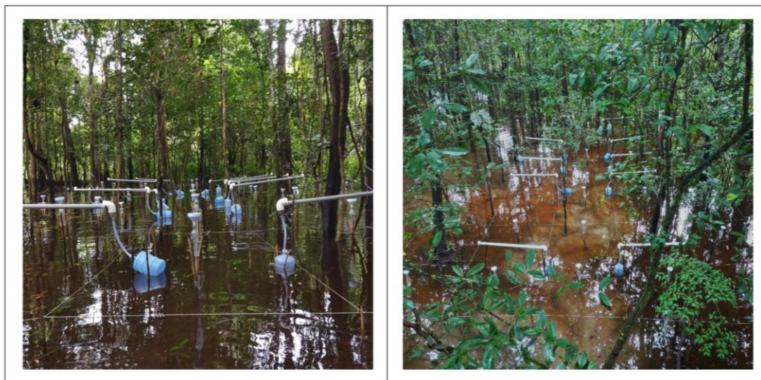
Figura 2 – Monitoramento da chuva interna: pluviômetros artesanais distribuídos na parcela e sistema de calhas ligadas a galões com medição manual
