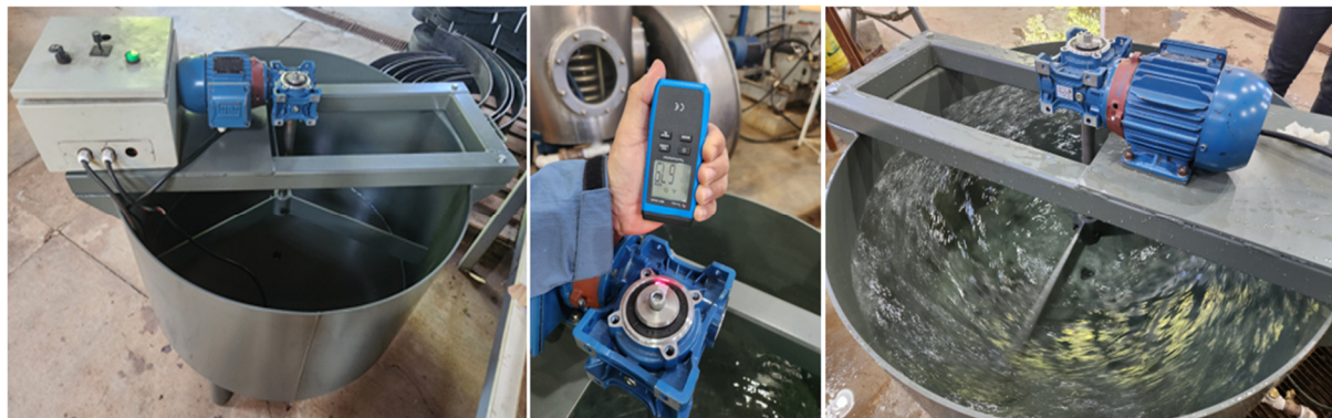
Figura 7 - Equipamento de abrasão submerso desenvolvido na Unicamp
