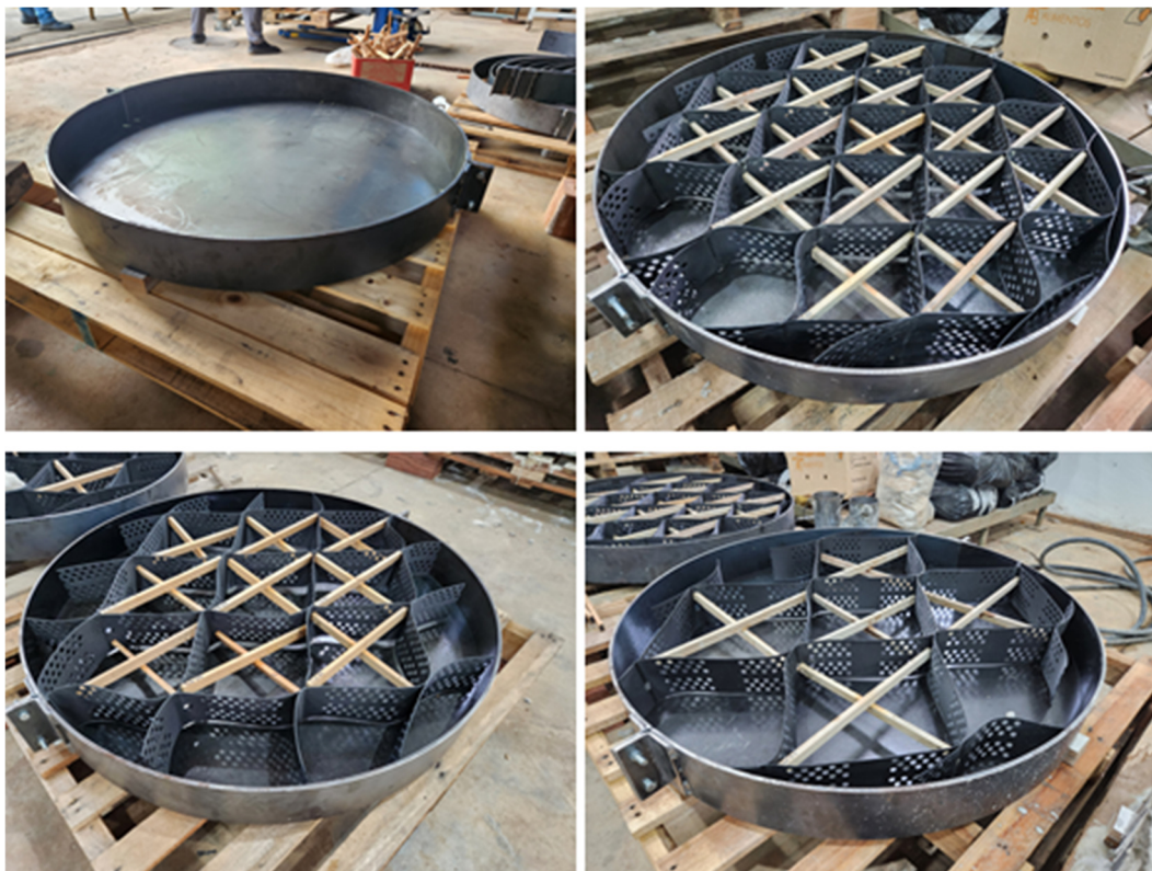
Figura 9 - Moldes e gabaritos de madeira para manter as aberturas da geocélula
