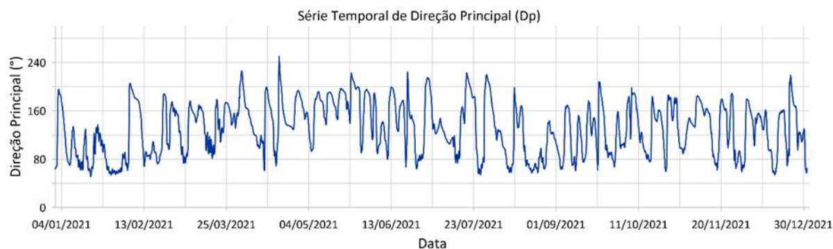
Figura 5: Série temporal com informações de Direção Principal (Dp) de ondas para o ano de 2021. As direções indicam os azimutes de origem das ondas.
