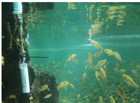
Figura 2 – Disposição do sensor de oxigênio dissolvido miniDOT® no ponto Aquário
