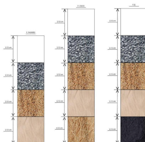
Figura 1: Esquema dos biofiltros: padrão, com fibra de coco e com carvão ativado de Ziziphus Joazeiro .
