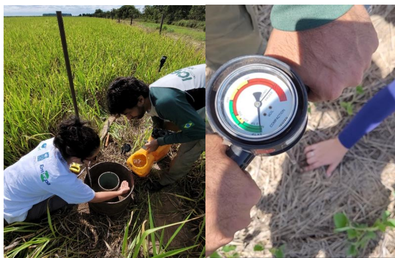
Figura 2 – Teste de infiltração utilizando o Infiltrômetro de anéis concêntricos (figura da esquerda) e Teste de resistência a penetração (figura da direita).
