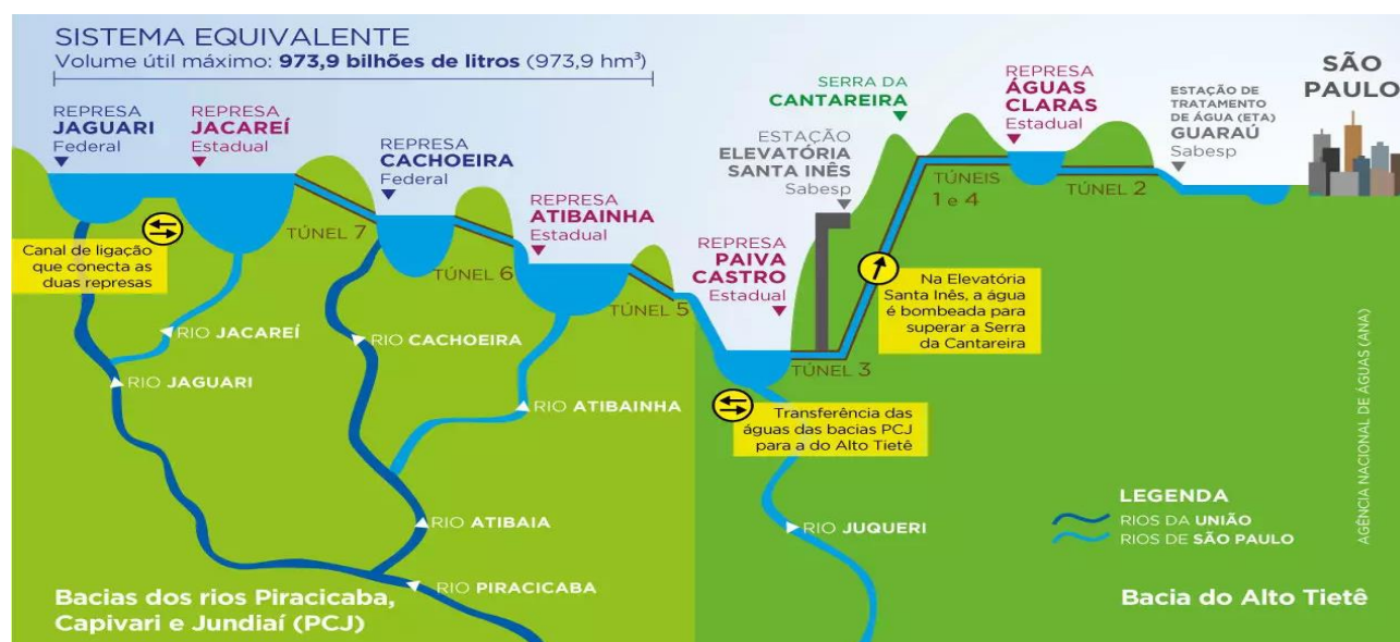
Figura3: Perfil Hidráulico Sistema Cantareira. — Fonte: Site Agência Nacional de Águas.
