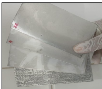
Figura 1 – Eletrodos de alumínio após serem utilizados nos testes
