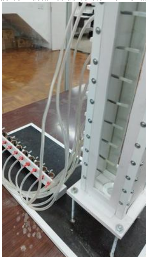
Figura 6 Modelo em escala da coluna de decantação com detalhes do coletor horizontal
