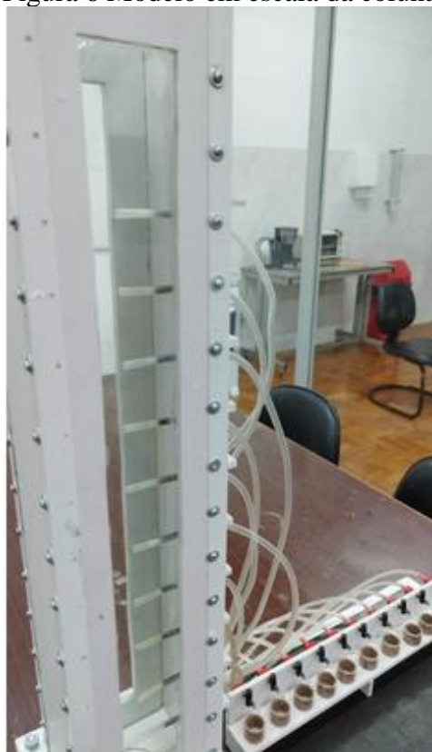
Figura 6 Modelo em escala da coluna de decantação com detalhes do coletor horizontal
