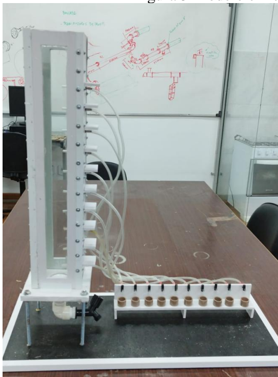
Figura 6 Modelo em escala da coluna de decantação com detalhes do coletor horizontal
