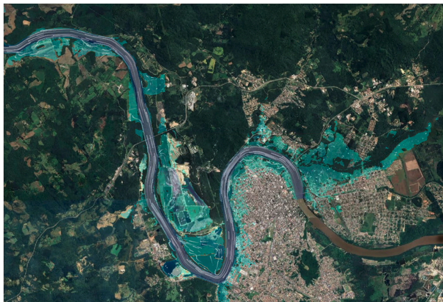
Figura 2 – Mancha de inundação obtida por modelo hidrodinâmico em outubro de 2023 (a) e foto aérea do evento (b)
