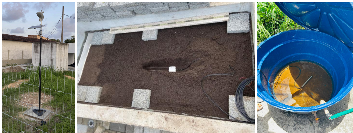
Figura 5 - Instrumentação: estação meteorológica, TDR e sensor de nível.
