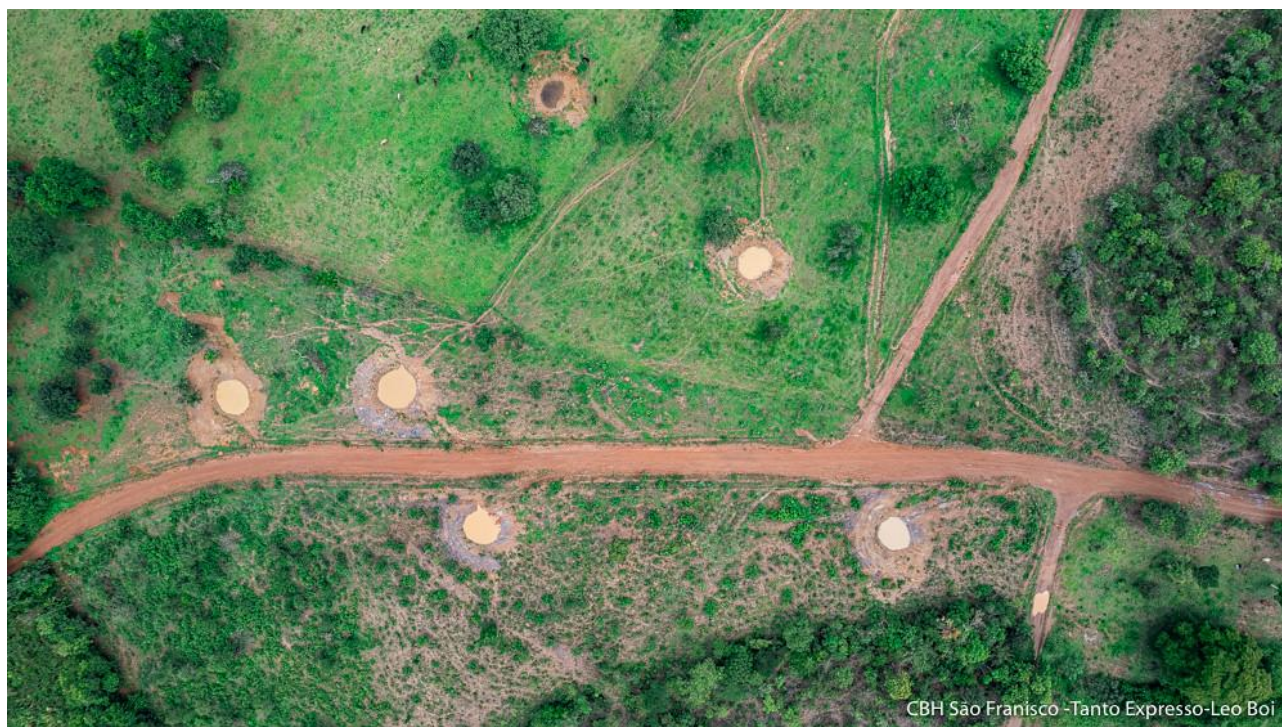
Figura 5 - Visão aérea de implantação de barraginhas para controle de infiltração e de mitigação de assoreamento
