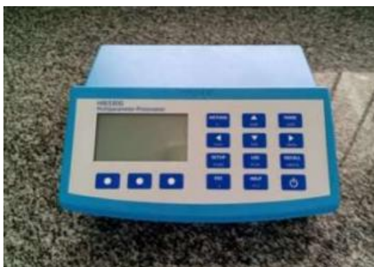
Figura 1 - Fotômetro Multiparâmetro da marca Hanna
