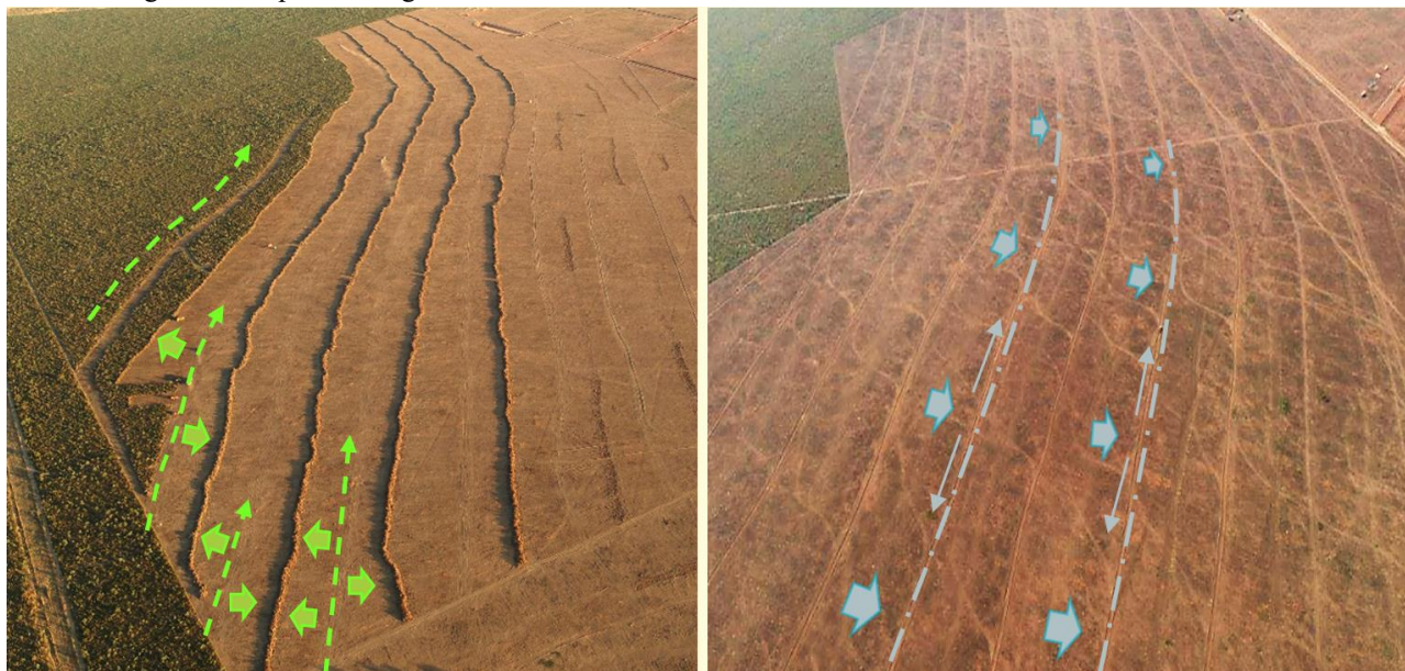
Figura 9 – Supressão vegetal realizada corretamente, mediante acessos auxiliares em curvas de nível.
