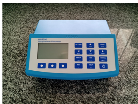
Figura 2 - Fotômetro Multiparâmetro de marca Hanma – modelo HI83300 (Autoria Própria, 2025)
