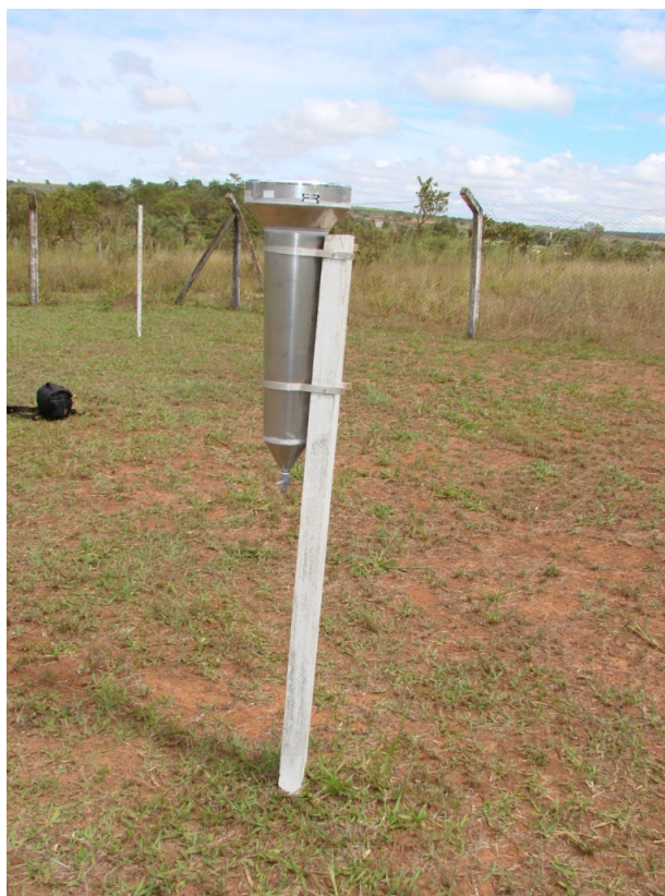
Figura 2: Pluviômetro convencional tipo Ville de Paris
