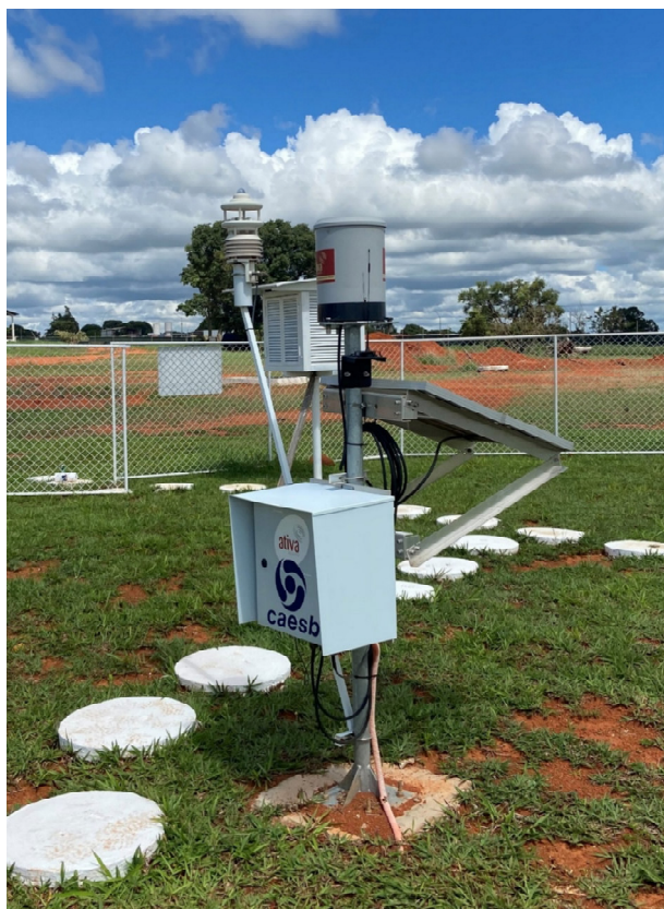
Figura 3: Pluviômetro automático com telemetria
