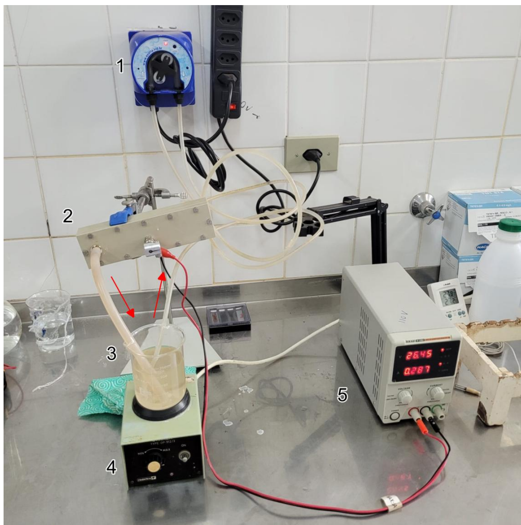
Figura 1 – Sistema de oxidação eletroquímica. Legenda: (1) Bomba peristáltica; (2) Célula eletroquímica; (3) Reservatório da amostra; (4) Agitador magnético; (5) Fonte de alimentação; Setas indicam sentido de circulação da amostra no sistema.
