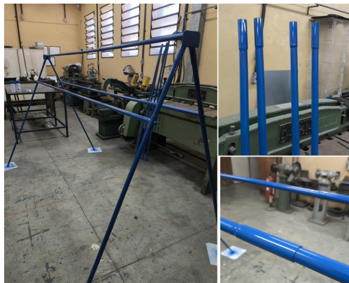
Figura 1 – Estrutura desmontável, com detalhes dos encaixes entre os tubos.
