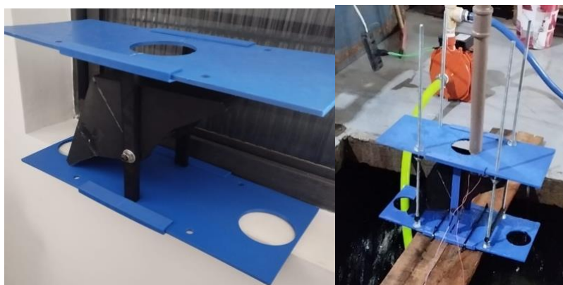
Figura 1: Medidor de vazão basculante parcialmente montado e em fase de teste
