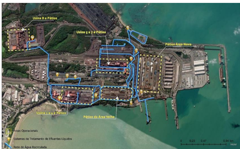
Figura 1 – Sistema Integrado de Tratamento de Efluentes Líquidos contendo Minério de Ferro – SRAI N° 1 e SRAI N° 2 – Anel de água recirculada Unidade Tubarão/ES.
