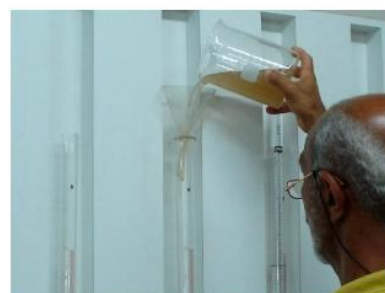
Colocação da amostra no tubo
