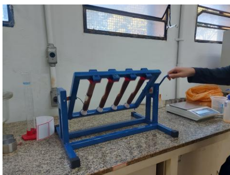
Figura 4 – Acionamento do aparato de teste de velocidade de queda de partícula
