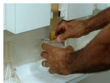
Coleta da amostra no fundo com a abertura da válvula
