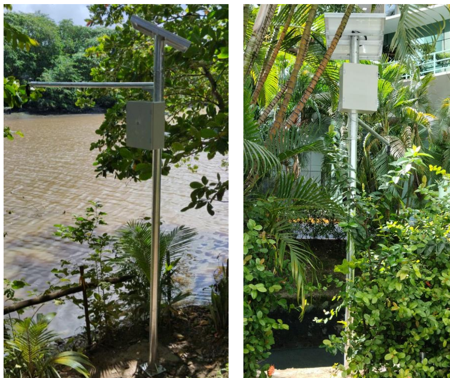
Figura 2 - Equipamentos de monitoramento de nível no rio Capibaribe (esq.) e riacho Parnamirim (dir.). Créditos da foto: João Erasmo (Tomus)
