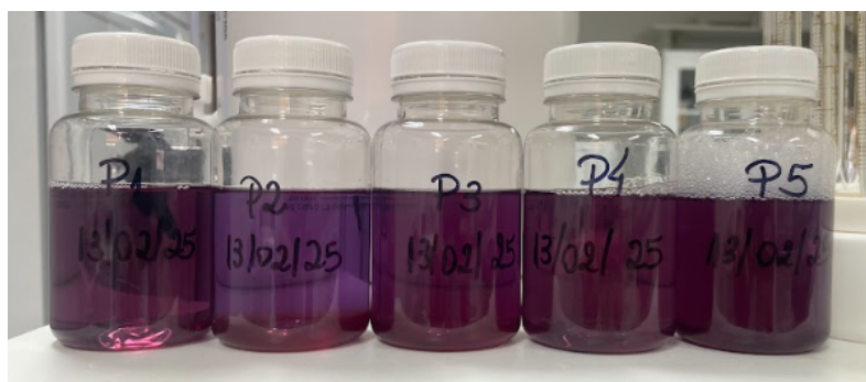
Figura 1 – Amostra com meio de cultura Colitest® apresentando coloração púrpura antes da incubação.
