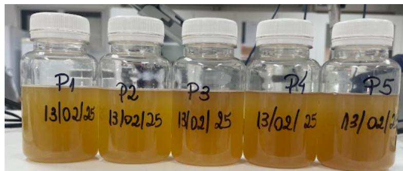
Figura 2 – Frascos Colitest® apresentando coloração amarelada, indicativa de presença de coliformes totais, nas amostras de água superficial do rio Pardo coletadas em fevereiro de 2025.
