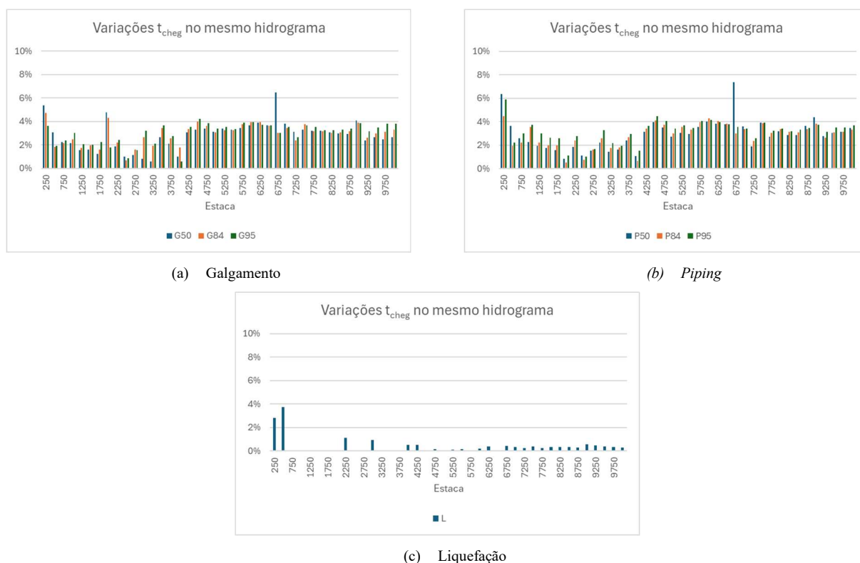
Figura 8 – Variação máximas do tempo de chegada para diferentes modos de falha
