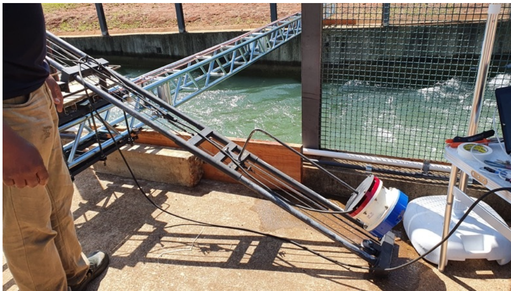
Figura 2 - Acoustic Doppler Current Profiler (ADCP) em medição na Escada para Peixes da UHE Porto Primavera
