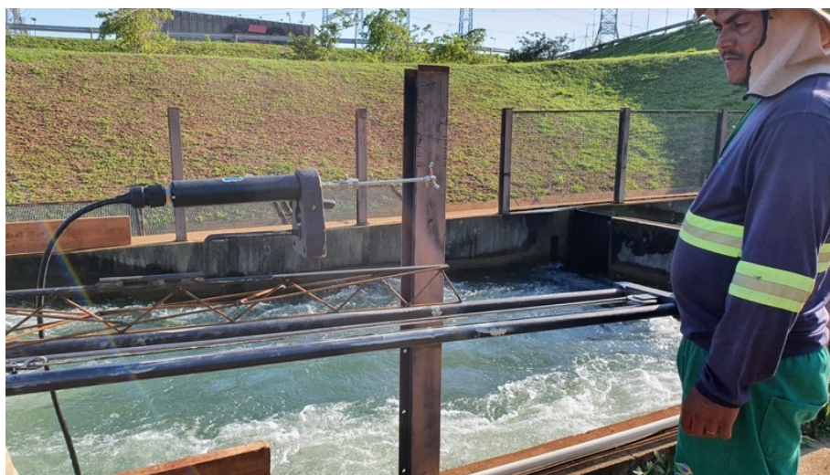
Figura 1 - Acoustic Doppler Velocimeter (ADV) em medição na Escada para Peixes da UHE Porto Primavera
