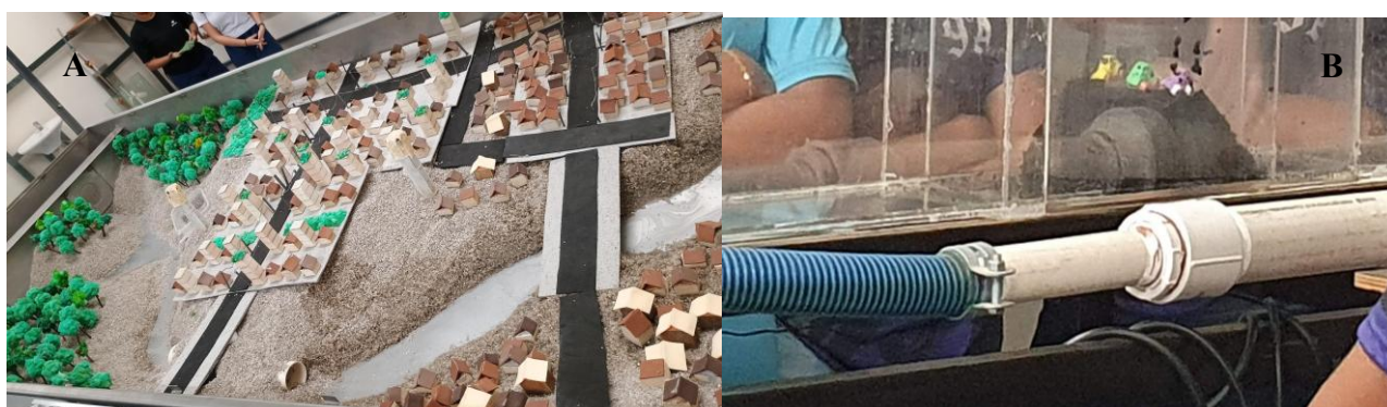
Figura 5 – Aplicação do Módulo III e IV no Centro Federal de Educação Tecnológica de Minas Gerais: A) Simulação de Chuva e B) Simulação de efeitos de enchentes.
