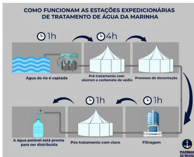
Figura 1 – Funcionamento das Estações de Tratamento de Água Móveis da Marinha – Agência Marinha (2024)
