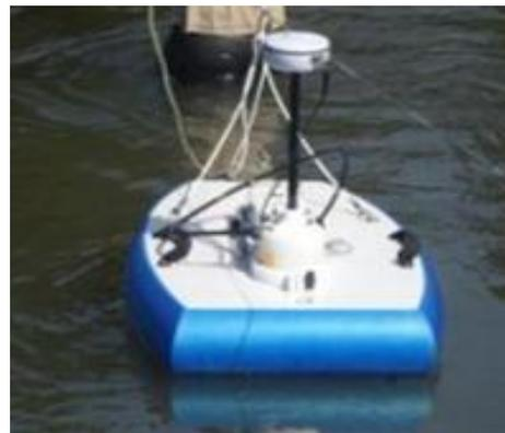
Figura 7- Medição de vazão na seção transversal do Rio Piranhas-PB
