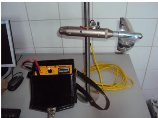
Figura 3- Molinete Fluviométrico com contador de pulsos
