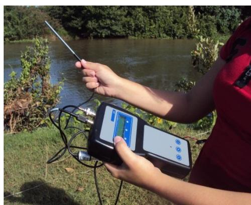
Figura 10- Medição da Temperatura do ar
