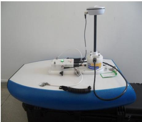
Figura 6- Medidor acústico Doppler de vazão
