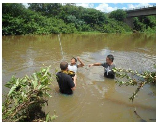
Figura 4- Medição de vazão *in-locu*
