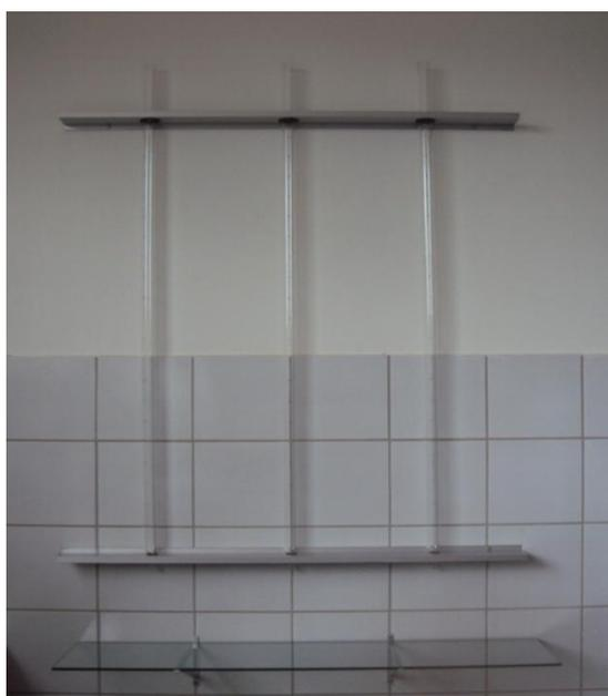
Figura 6 - Conjunto de três tubos de vidro graduados para método do tubo de retirada pela base
