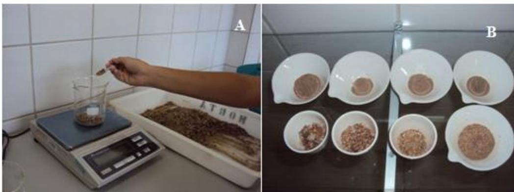
Figura 8 - Pesagem do material de fundo (A) e material separado de cada peneira (B)
