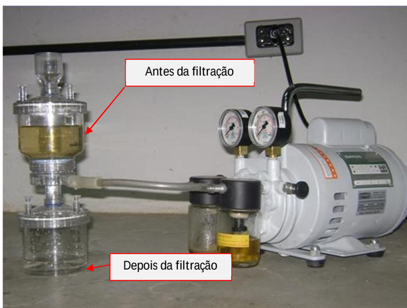
Figura 3 - Conjunto de filtração a vácuo para a retirada do material em suspensão
