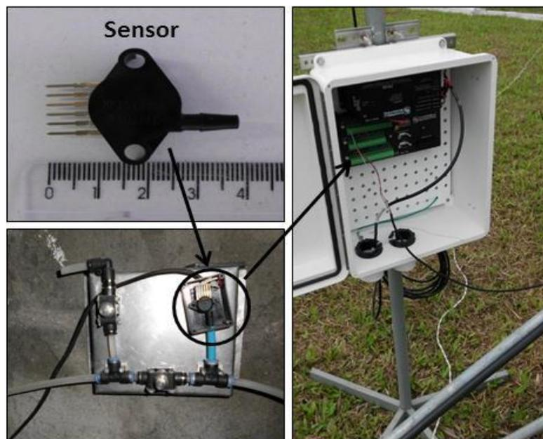
Figura 2. Detalhe do sensor de pressão hidrostática conectado ao microprocessador data logger.
