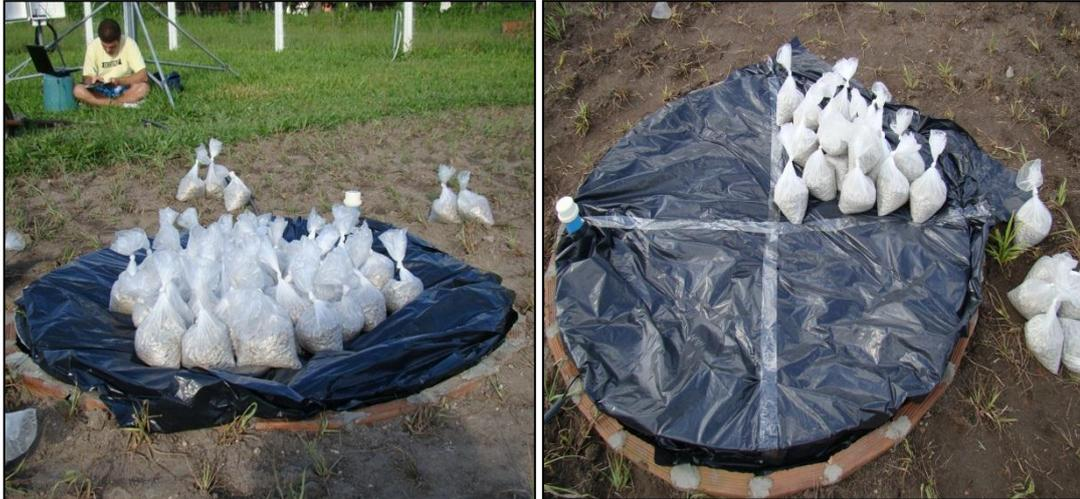
Figura 3. Ensaio de calibração com carregamento e descarregamento de massas padrão no centro e nos quadrantes do lisímetro.
