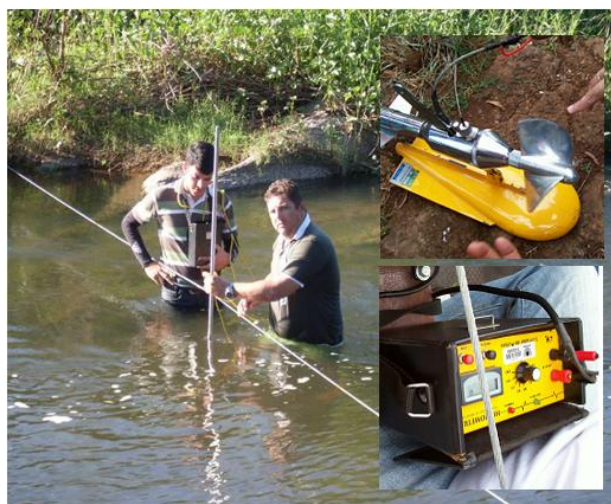
Figura 3 - Medição de vazão com o molinete fluviométrico e contador de pulsos na seção transversal do Rio Piancó
