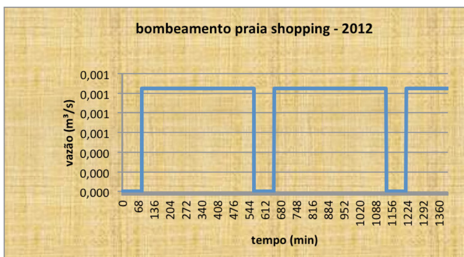
Figura 6 – Simulação do funcionamento da EE Praia Shopping em 2012.
