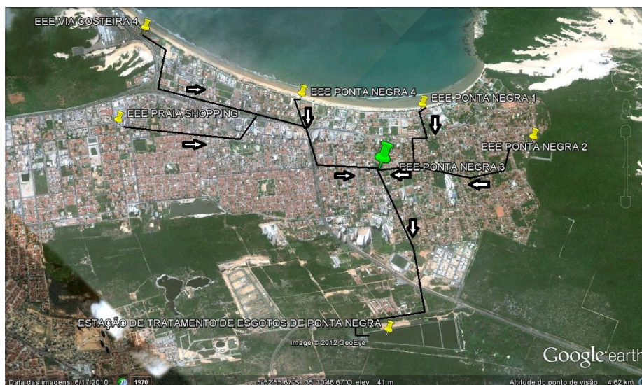
Figura 1 – Esquema do SES do bairro de Ponta Negra e localização das estações elevatórias.
