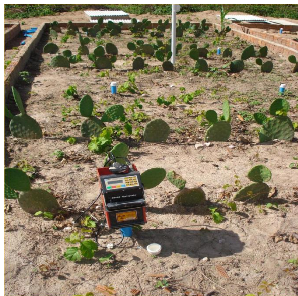
Figura 3: Sonda de nêutrons utilizada na medição da umidade do solo
