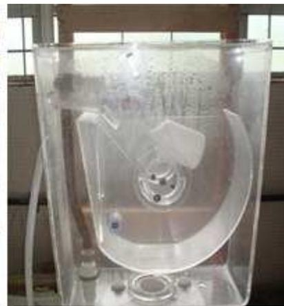
**Figura 8:** Caixa de Descarga Econômica e Ecológica
