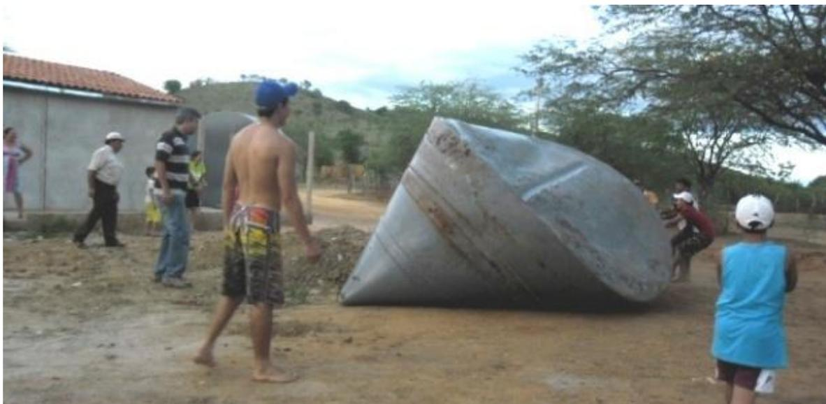
Figura 4 – Cisterna de Polietileno deformada no município de Cedro - CE
