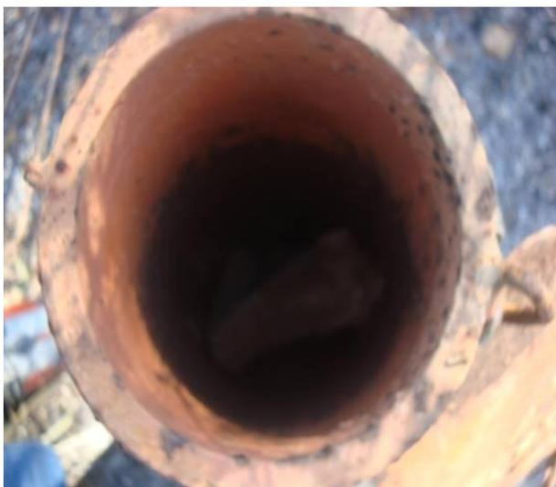
Figura 23 - Piezômetro entupido.
