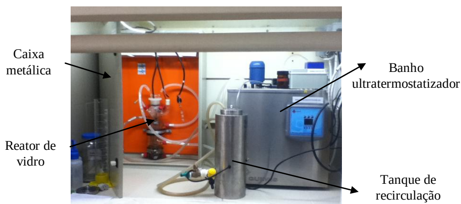
Figura 7 - Sistema operacional do Reator Anular Fotoquímico.
