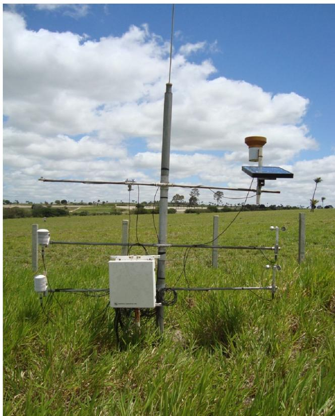
Figura 1 – Torre micrometeorológica automatizada instalada na área experimental para a realização do balanço de energia
