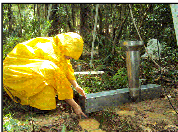
Figura 4 – Coleta de água para medição de vazão.
