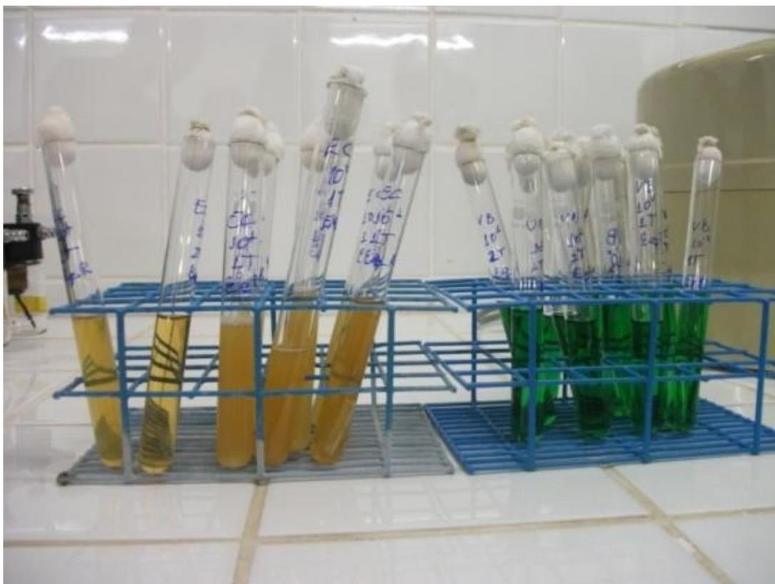
Figura 7 - Análise de coliformes fecais (E. C.) à esquerda e coliformes totais (verde brilhante) à direita.
