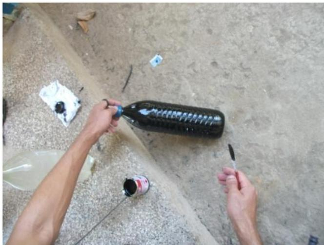
Figura 3 – Garrafa pintada na cor preta para melhor absorção de raios solares.
