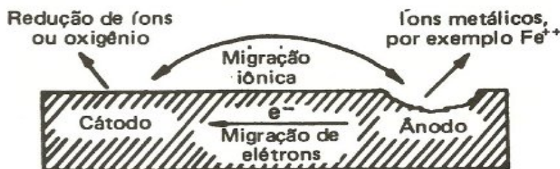
Figura 19 – Esquema simplificado da corrosão eletroquímica (Drew, 1979).
