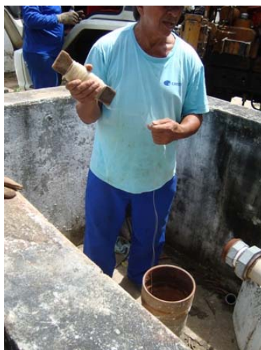
Figura 5 – Operador medindo a profundidade do poço.
