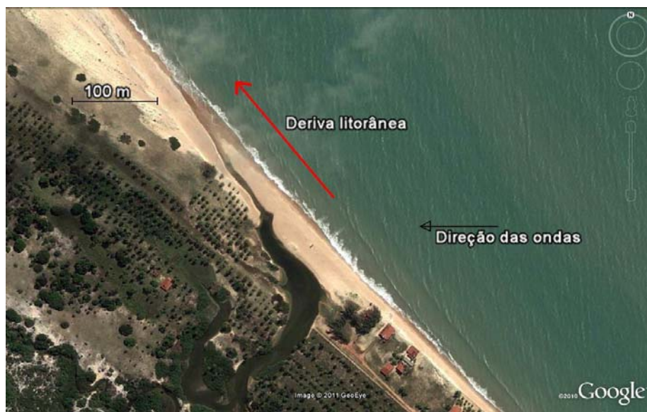
Figura 8 – Orientação do rio riachos na parte central da praia de Pititinga/RN aponta deriva litorânea de sedimentos de sul para norte. Fonte: Google (Data das imagens: 08/01/10).
