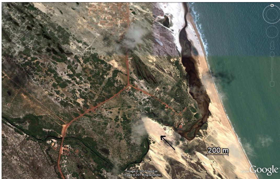
Figura 7 – Imagem mostrando o processo de assoreamento do rio Punaú-RN próximo à sua desembocadura. A seta indica o sentido de transporte dos sedimentos pelo vento. Fonte: Google (Data das imagens: 08/01/10).
