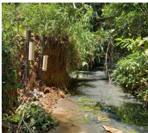
Figura 2 – Garrafas Nava posicionadas nas margens do córrego
